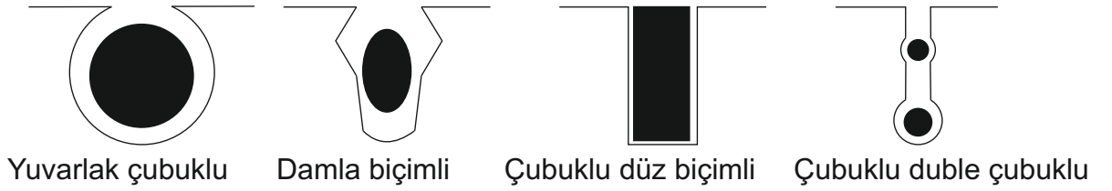
Şekil- 15.3 : Rotor çubuk biçimi ve kesiti
