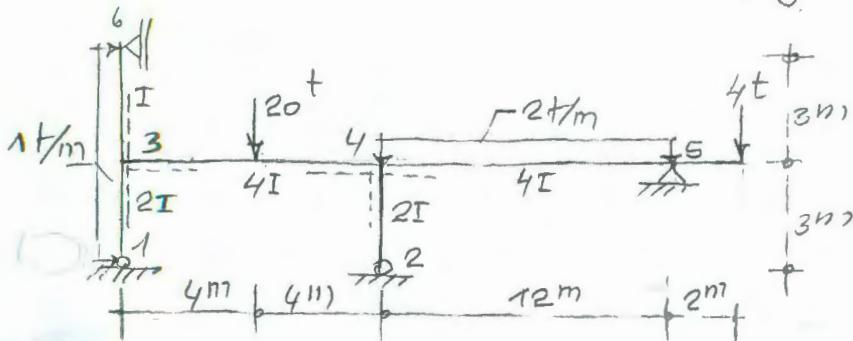
Çözüm : \* D.N. S. Sistemi; çözüm tek sefli, \* Cubuk Redüksiyonu; \* Degrıtmaz katsayıları
