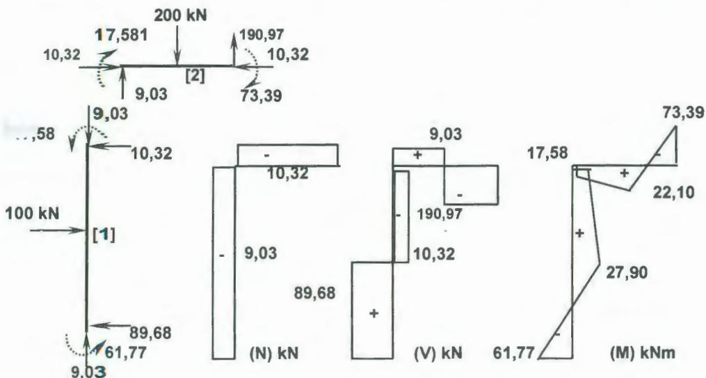
**SORU 10:** Ölçü ve yükleme durumu verilen sistemde B noktasının, (10p) yatay yer değiştirmesi  $\delta_B^H$  ve dönmesi  $\phi_B$  değerlerini bulunuz.
