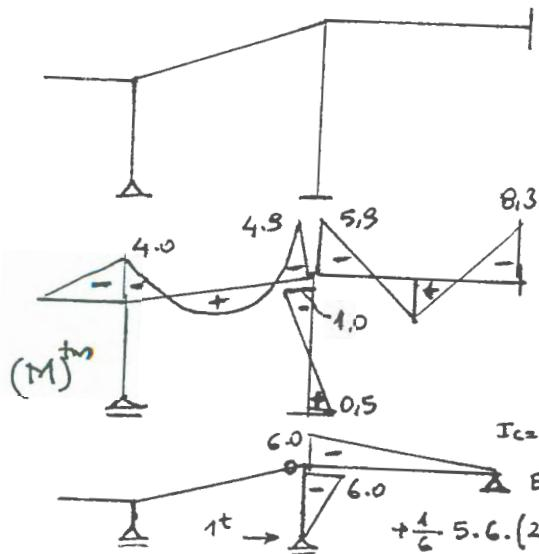
**SORU 2:** Ölçü ve yükleme durumu şekilde verilen taşıyıcı sistemi Açı yöntemi ile çözerek iç kuvvet ( $M, V, N$ ) diyagramlarını çiziniz.
