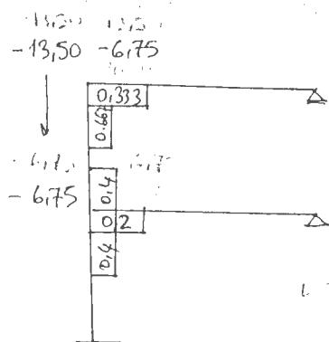
Ölçü ve yükleme durumu verilen çerçeveyi moment dağıtma / cross yöntemiyle göstererek kesit kuvveti diy. q'zintiz.
