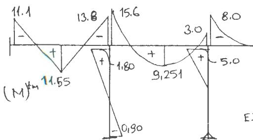
**SORU 2:** Ölçü ve yükleme durumu şekilde verilen taşıyıcı sistemi Açı yöntemi ile çözerek iç kuvvet ( $M$ ,  $V$ ,  $N$ )
