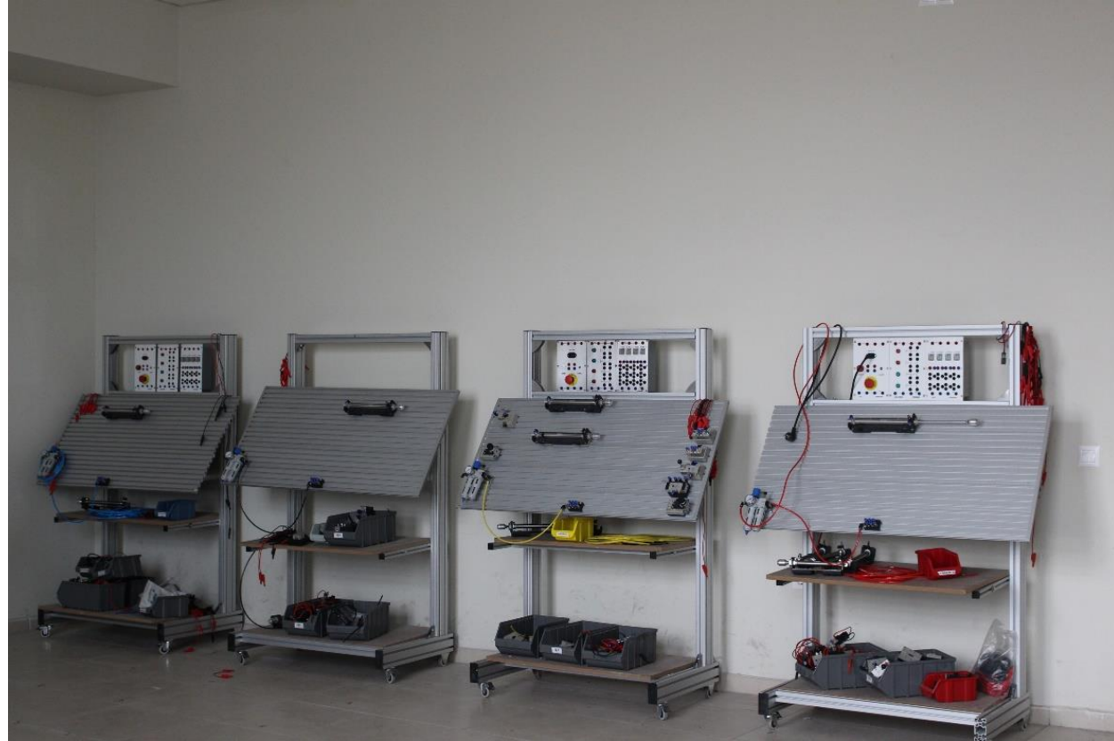
Bölüm içi imkanlarla ortaya koyduğumuz ve aktif olarak kullandığımız Hidrolik-Pnömatik Deney Setleri
