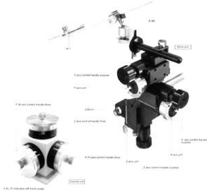
Şekil 5.4: Mikroelektrot tutucusuna bir mikroelektrot bağlanmış bir hidrolik mikromaniplatör. Kontrol kollarının döndürülmesi ile mikroelektrot her üç yönde (x,y,z) hem makro hem de mikrometre boyutunda hareket ettirilebilmekte ve böylece mikroelektrot ucu hedef hücre üzerinde manüplasyon yapmaya olanaklı hale gelmektedir (Fotoğraf Narishige web sayfasından alınmıştır).
