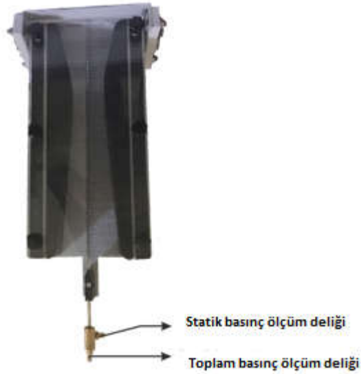
Şema 1: Pitot-Statik basınçölçerin şematik gösterimi
